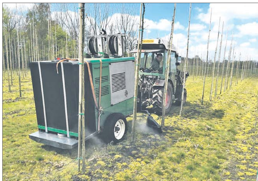
BioMant Aqua WS-Agro von Mantis ULV zur Unkrautbekämpfung mit Heißwasser. Werkfoto
